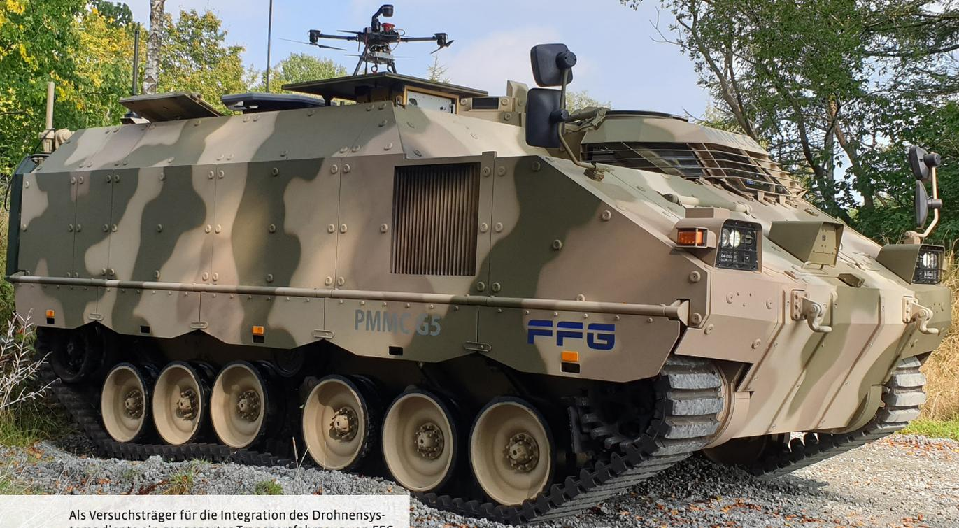
Als Versuchsträger für die Integration des Drohnensystems diente ein gepanzertes Transportfahrzeug von FFG.
