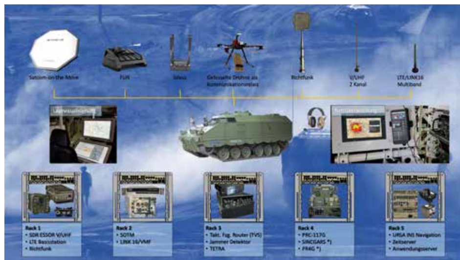
Schematische Darstellung G5 Demonstrator
