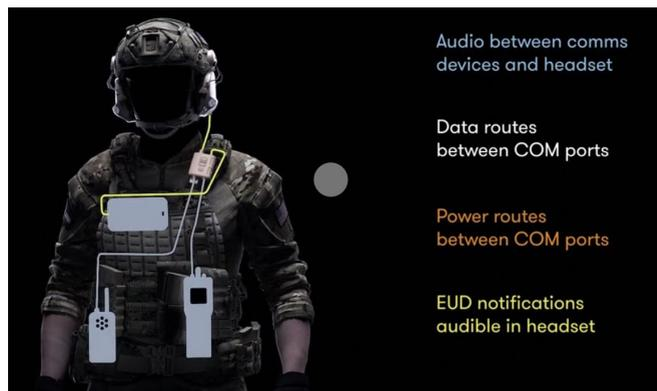
Benachrichtigungen aus dem BMS-System und Sprachanfragen vom EUD können über das integrierte digitale Audio empfangen/abgehört werden.
