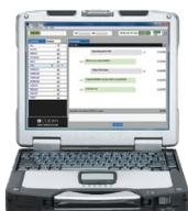
**SPRINT:** Die **STANAG 5066-konforme** SprintNet-Anwendung nutzt die Vorteile der 3G-ALE-Wellenform, um Verbindungen schnell und sicher bereitzustellen.
