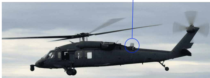
Ovzon Mini OTM – erfolgreicher Flug auf UH-60, 17/17 Mbps durch die Rotoren
