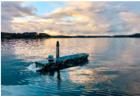
Erfolgreicher Test eines OVZON P30 auf einem USV (unbemanntes Wasserfahrzeug)
