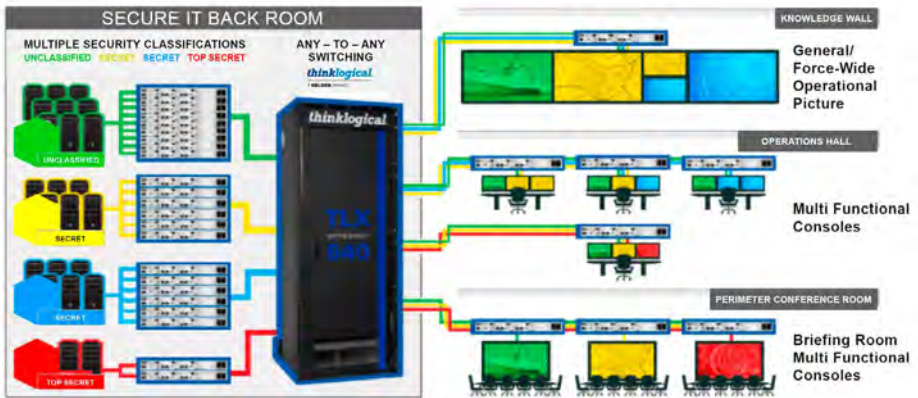
Schematische Funktionsdarstellung der Thinklogical Enterprise Level KVM-Architektur
